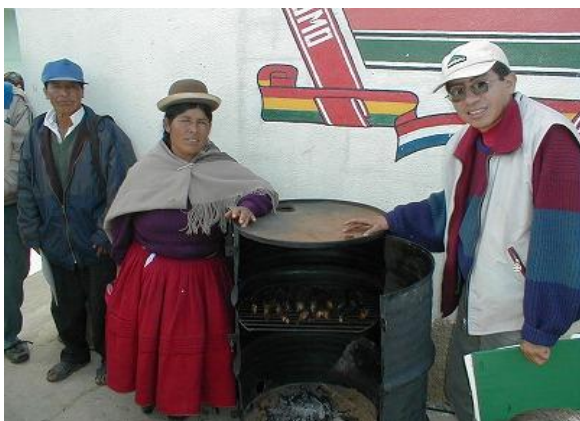
写真2-6 ドラム缶で作成された普及用の簡易燻製機。研修でのコマ。
