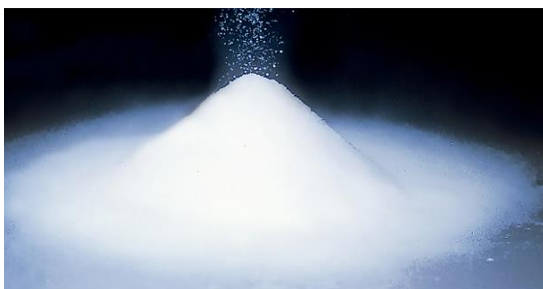
写真1-5 レオロシール：多結晶シリコン製造工程で派生する四塩化珪素(SiCl 4 )を原料とする煙霧状シリカ。
